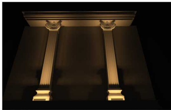
وال واشر امیر ۱۰ درجه با فاصله ۱۰ سانتی متر از ستون با زاویه قائم
