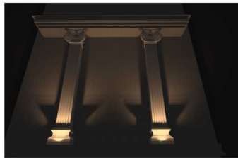
وال واشر امیر ۳۶ درجه گرد با فاصله ۱۰ سانتی متر از ستون با زاویه قائم
