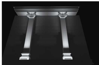
وال واشر ۱۰ درجه با فاصله ۱۰ سانتی متر از ستون با زاویه ۱۰ درجه متعامل به نما
