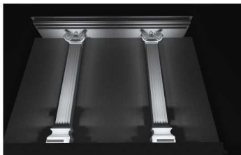
وال واشر ۱۰ درجه با فاصله ۱۰ سانتی متر از ستون با زاویه قائم
