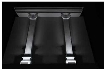
وال واشر ۲۶ درجه با فاصله ۱۰ سانتی متر از ستون با زاویه قائم
